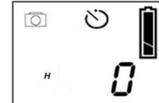
Drücken Sie die Modus-Taste, bis das Selbstauslöser-Symbol angezeigt wird. Drücken Sie auf den Auslöser.
