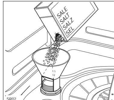
**i** Сигнальная лампочка "Заполнение соли" может остаться гореть еще в течение 2 - 6 часов после засыпки соли, допуская включение машины. При использовании соли, которая растворяется в течение более длительного времени, лампочка может гореть еще дольше. Кто не мешает работе посудомоечной машины.
