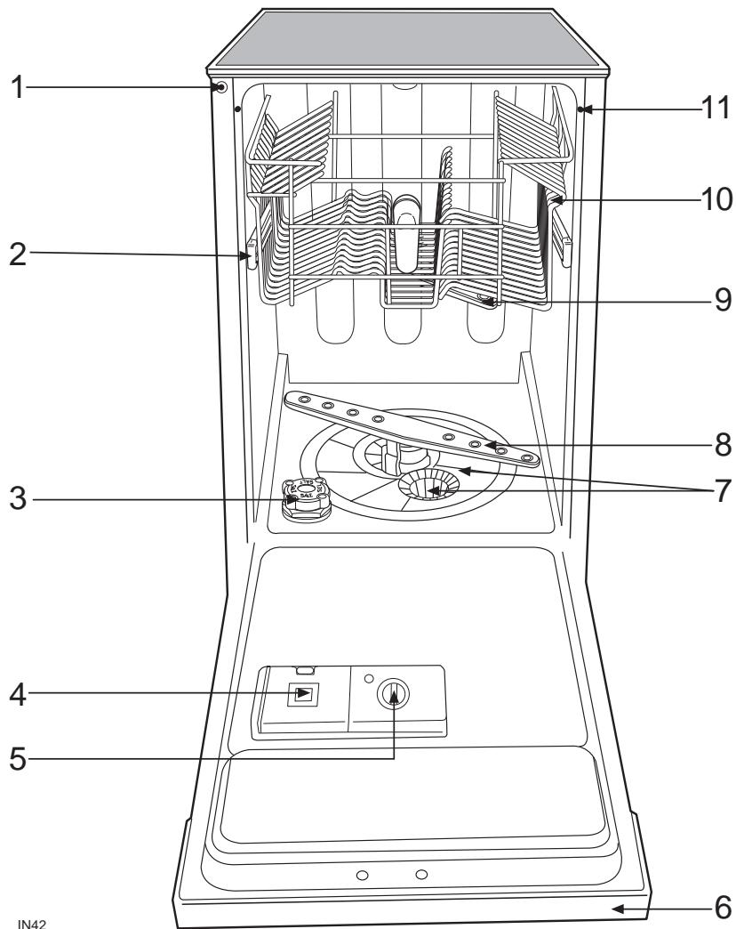
1. Регулятор устройства для смягчения воды
