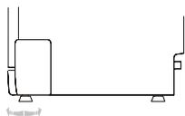
После установки машины ее следует выровнять при помощи ножек (регулируя их высоту) для выставления по уровню. Максимальная погрешность не должна превышать 2'.
