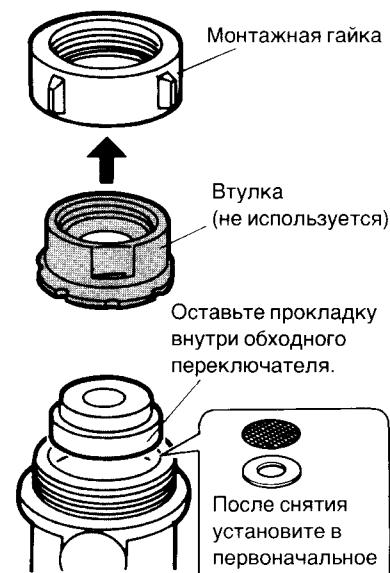
**3 Удалите из переходника винты, установите его на обходной переключатель и затяните гайкой.**
