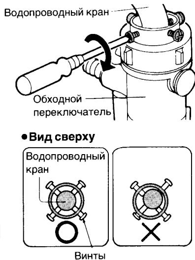
**6** Затяните монтажную гайку, вращая ее по часовой стрелке.
