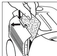
Откройте боковую крышку до упора. Выньте использованный микрофильтр, как показано на рисунке, и установите новый на его место.
