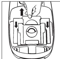
Из гигиенических соображений пылевой мешок следует менять следующим образом: при вытягивании мешка за язычок (как показано на рисунке) отверстие мешка автоматически закрывается. При вытягивании чувствуется некоторое сопротивление. Вставьте новый мешок до имеющейся на нём отметки. После этого крышка может быть закрыта. Если в пылесосе нет мешка, крышка не закрывается - не старайтесь закрыть её через силу.
