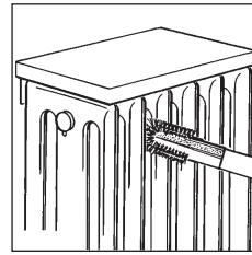
**Сопло для батарей парового отопления**
