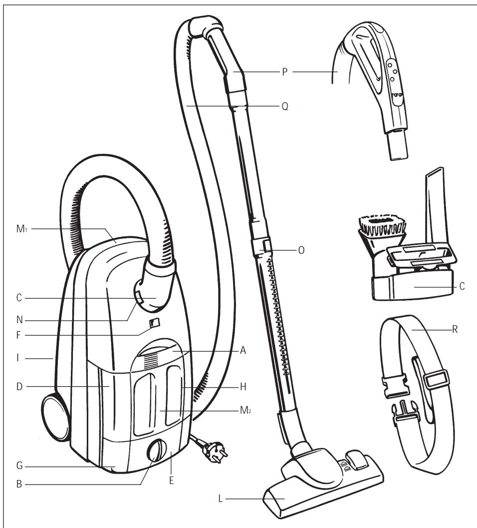
A = Кнопка открывания пылевого резервуара
