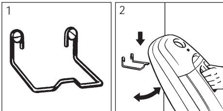
Настенный кронштейн можно прикрепить к стене с помощью прилагающихся винтов в целях экономии места (например, к внутренней стенке шкафа - толщина стены должна составлять не менее 16 мм). Если кронштейн крепится снаружи шкафа, нужно иметь в виду, что материал стены должен быть подходящим для этой цели, так как пылесос весит 5 кг (см. рисунки).
