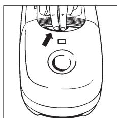
Открывание крышки пылевого резервуара выполняется нажатием на кнопку.
