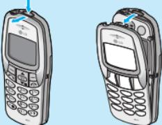
1. Для замены передней панели нажмите на защелку в верхней части корпуса например с помощью монеты. Начните снимать отошедшую переднюю панель с верхней ее части.
