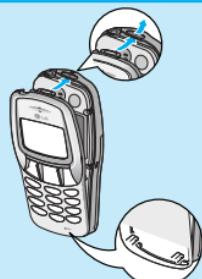
2. Для установки на место новой передней панели для начала вставьте нижнюю защелку в отверстие в нижней части корпуса, затем осторожно закройте верхнюю.
