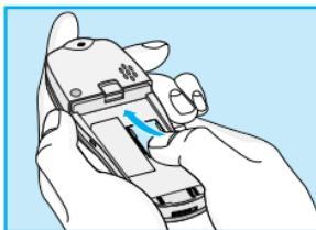
Гнездо для установки SIM-находиться на задней панели телефона. Следуйте следующим указаниям по установке SIM-карты.
