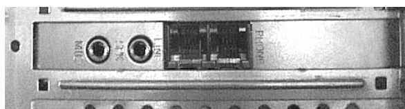
Рис.3 Acorp-PIM-2. Вид сзади после установки
