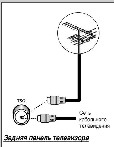
Вставьте штекер антенны или сети кабельного телевидения в коаксиальное антенное гнездо с маркировкой "75Ω", которое расположено на задней панели телевизора.
