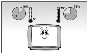
НЕ подвергайте телевизор воздействию очень высоких и очень низких температур (ниже 5°C и выше 35°C) или воздействию очень высокой и очень низкой относительной влажности (ниже 10% и выше 75%).
