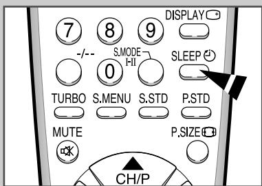
*Вы можете выбрать время до отключения телевизора по таймеру в диапазоне от 30 до 180 минут. По истечении установленного интервала времени телевизор будет автоматически переключаться в режим ожидания. Установки таймера сна выполняются с помощью кнопки "SLEEP ⏴".*
