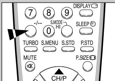
*Для выбора канала с номером 10 и выше с помощью цифровых кнопок выполните описанную ниже процедуру.*
