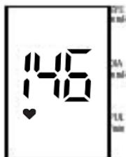
e) Cuando ha terminado la medición, suena un largo pip. En la pantalla aparecen los valores de la presión arterial sistólica , diastólica y el pulso medidos. La presión del brazalete puede ser eliminada, ahora, rápidamente, presionando la válvula de escape de la perilla de la bomba de inflado.
